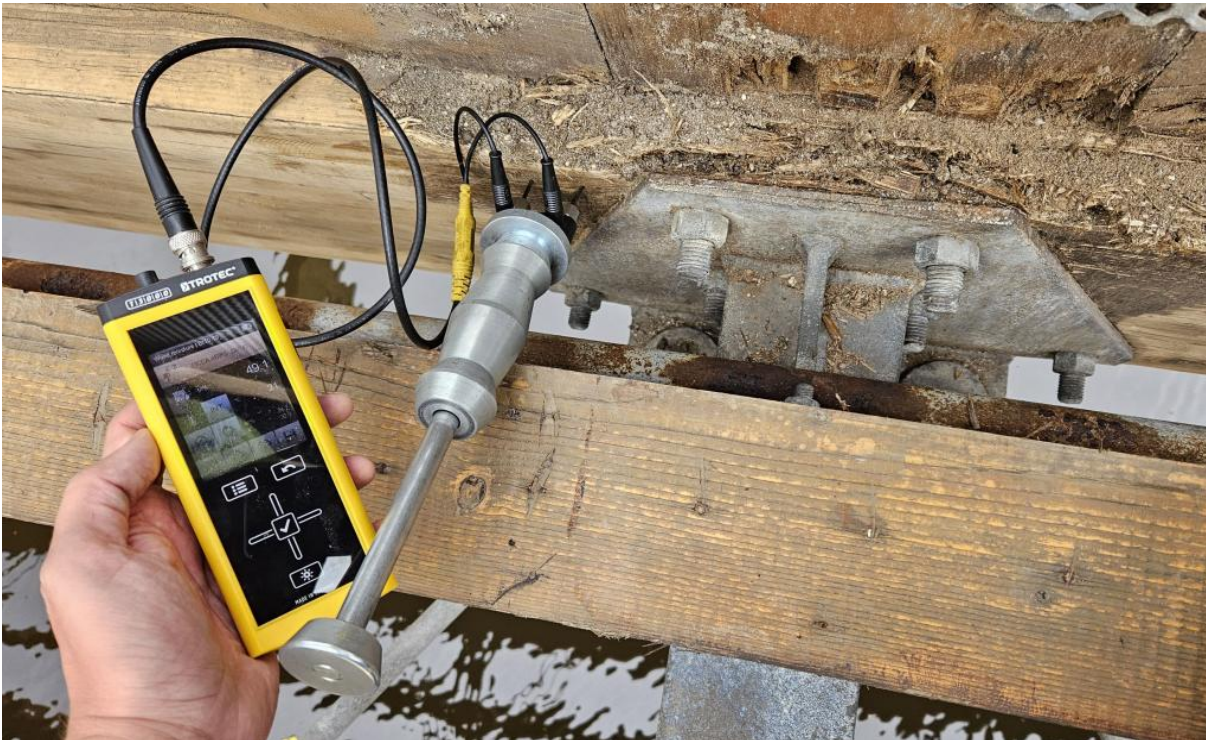
Měření vlhkosti dřeva odporovým vlhkoměrem Trotec
