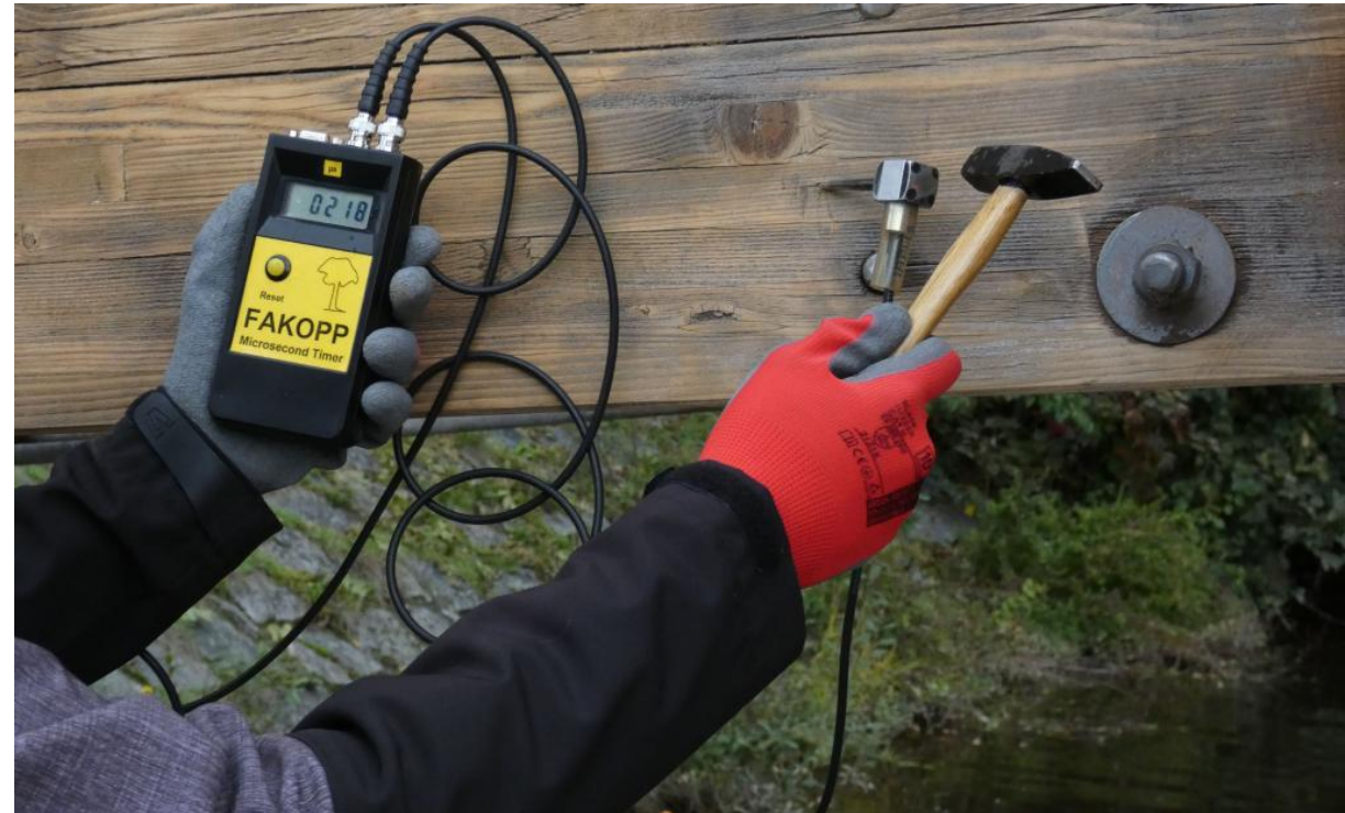
Měření rychlosti šíření rázové vlny přístrojem FAKOPP
