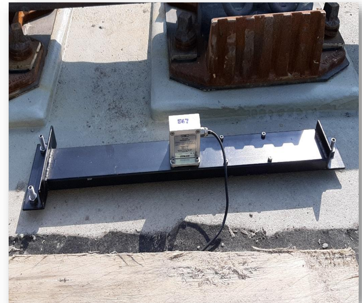
Detail umístění snímače náklonu
