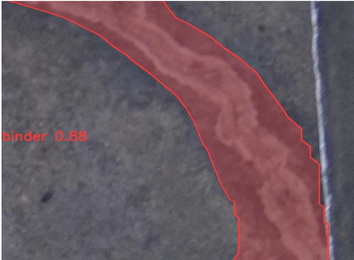
Detail detekce vady typu “Binder leaches / výluhy”.
