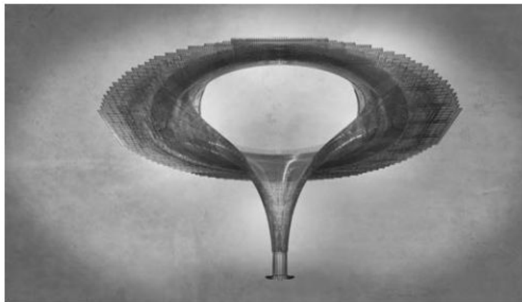
Bild 6 Schematische Darstellung der Bewehrung einer Kelchstütze samt Fuß Schematic representation of the reinforcement of a chalice-shaped column (Copyright: Werner Sobek, Stuttgart)
