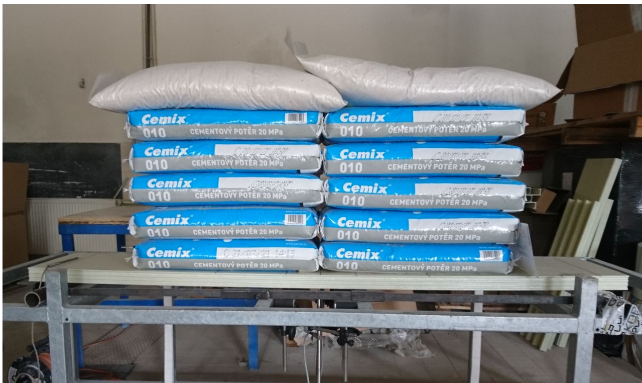
Obr. 26 Rozpětí 1500 mm, zatížení 300 kg
