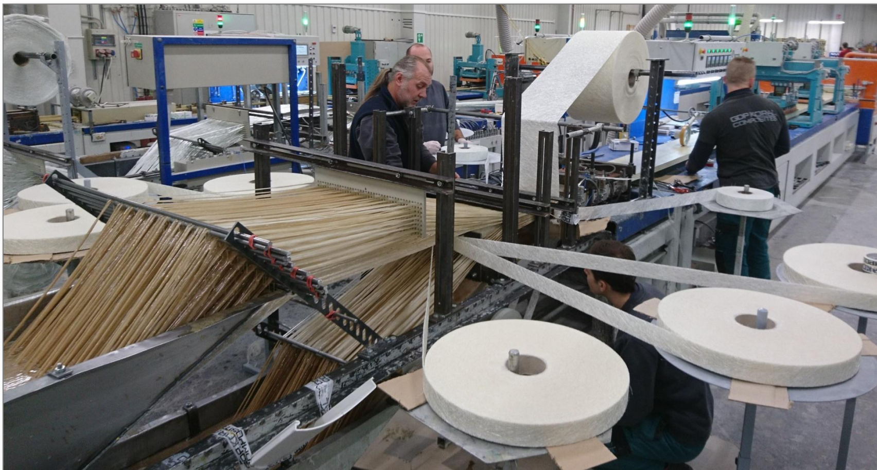
Obr.2 Výroba PLANK 40-300 v GDP KORAL v Tišnově
